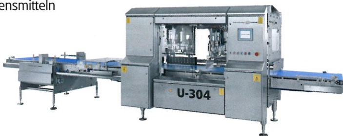
Das ultraschallunterstützte Schneiden verbindet Maschinenkomponenten zu einer ineinanderlaufenden Produktionsstraße.
